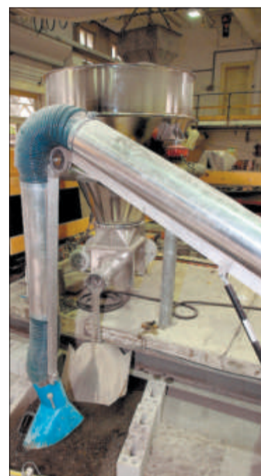
Eine Maschine lässt immer wieder Schutt ins Wasser fallen, die Menge gibt der Computer vor.
