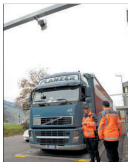
Andy Zimmermann (links) und Steven Peyer vermessen mit der neuen Anlage einen LKW. Der Computer zeigt dann auf dem Bildschirm die genauen Masse des Fahrzeugs an.
